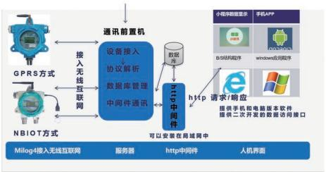
Milog4系列远传压力记录仪通过NB-iot网络透传方式,上报到电信CWTing平台,通过订阅的方式将数据转发到第三方服务器,服务器经过解析数据把数据以文件或者数据库的方式存储在服务器中,电脑端平台软件通过访问服务器获取相应的数据,手机端APP、微信小程序通过HTTP中间件获取服务器中数据,平台软件扩展性强,可提供二次开发的数据访问接口。
